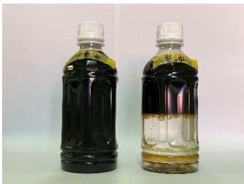
左 ナノ・プラズマ粒子 45%+油55% 右 水道水45+重油55%
