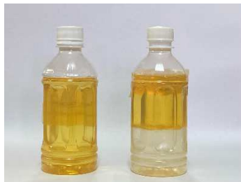
左 ナノ・プラズマ粒子 45%+油55% 右 水道水45+軽油55%
