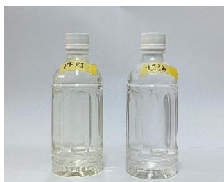
左 ナノ・プラズマ粒子 45%+油55% 右 水道水45+灯油55%
